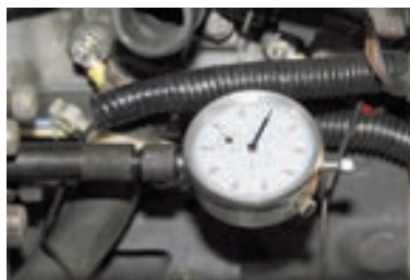
Medición de la carrera del émbolo con comparador
