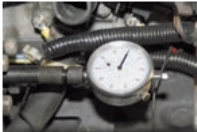
Vista de un regulador centrífugoMedición de la carrera del émbolo con comparador
