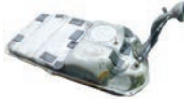
Depósito de combustible y tapón con válvula de seguridad
