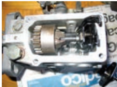
Vista de un regulador centrífugo
