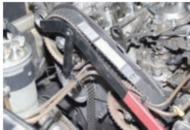
Giro manual del motor
